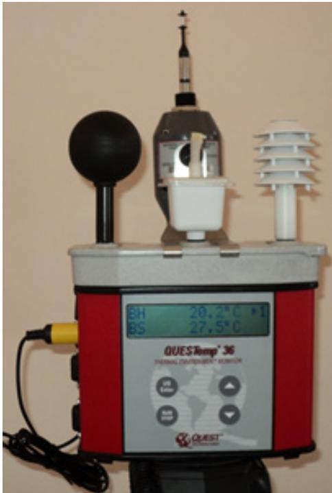
Figura 2. Monitor de estrés térmico con el que se realizaron las mediciones físicas.
