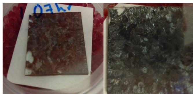
**Figura 2.** Películas de perovskita a) sin tratamiento térmico y b) tratamiento térmico ( $200^\circ\text{C}$ ).
